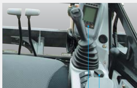
Показан экскаватор в комплектации с рычагом управления дополнительным рабочим оборудованием.
