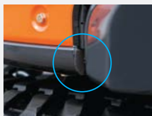
Боковые лонжероны D-образного сечения
